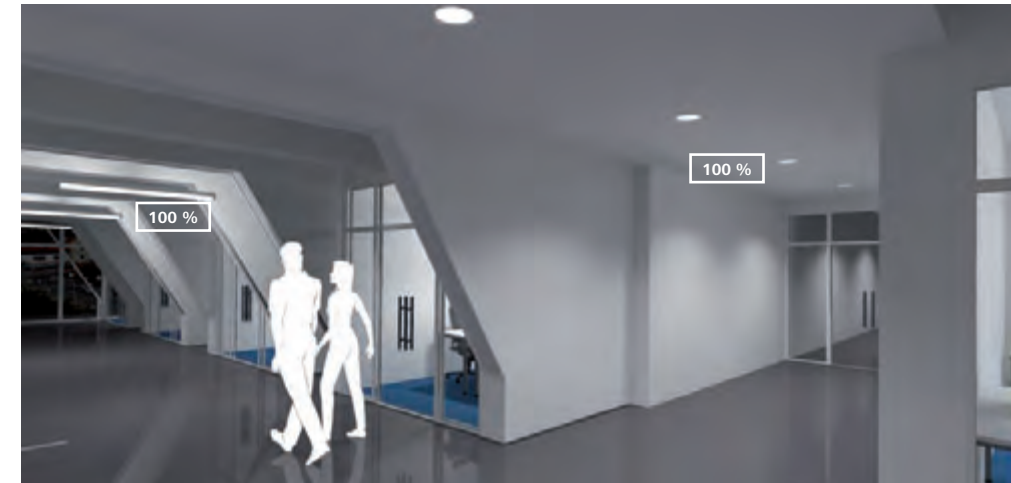
Wenn im nächsten Scanbereich eine Bewegung wahrgenommen wird, gehen die Lampen in der nächsten Zone an.
