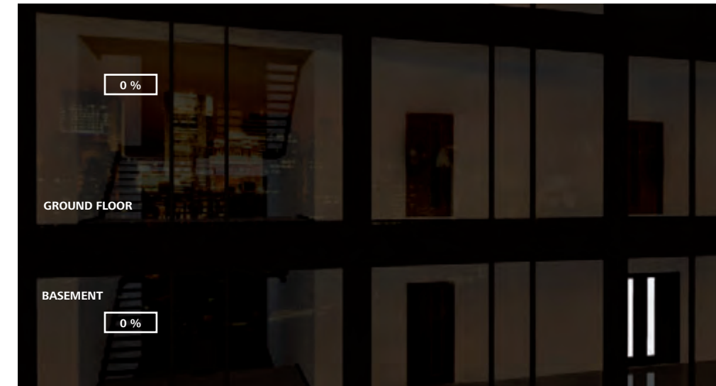
Bis eine Bewegung auf irgendeiner Etage wahrgenommen wird, bleiben alle Leuchten ausgeschaltet.
