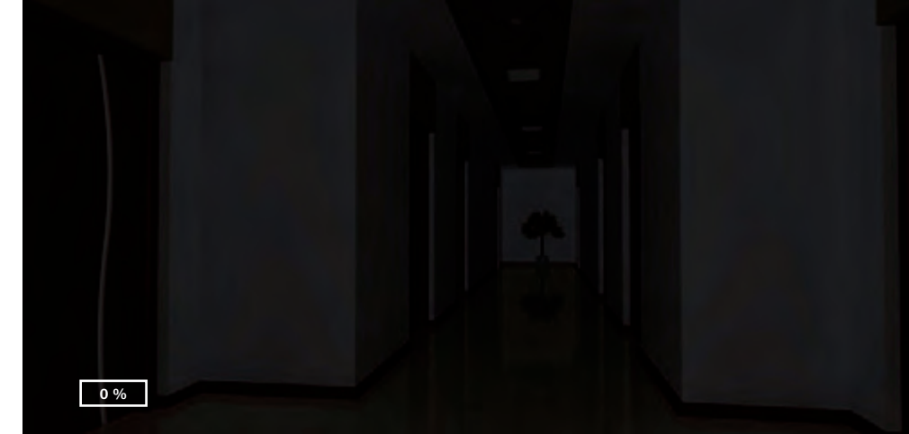
Bis die Bewegungssensoren eine Bewegung erfassen, bleiben die Leuchten ausgeschaltet.
