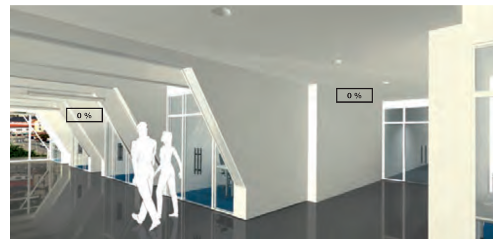
Wenn der Raum über genügend Tageslicht verfügt und das Beleuchtungslevel den voreingestellten Anforderungen entspricht, gehen die Lampen in beiden Zonen nicht an, auch dann nicht, wenn eine Bewegung wahrgenommen werden sollte.
