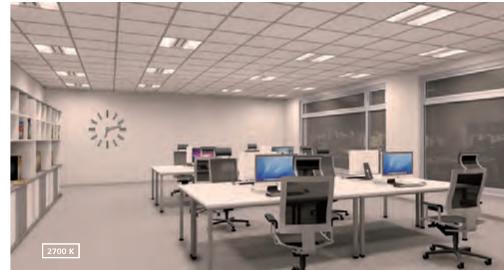
Die Änderung der korrelierten Farbtemperatur erfolgt automatisch nach einer voreingestellten Logik. Die korrelierte Farbtemperatur von Weißlicht in dem beschriebenen Raum ist 2.700 K.
