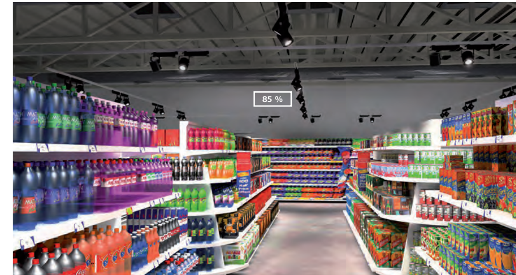
Alle Leuchten haben die gleiche Lichtleistung und funktionieren als eine Gruppe.
